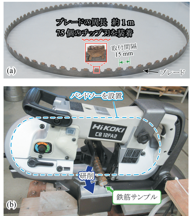
図4 チップ刃を装着したバンドソー(a)と研削試験の概況(b)
