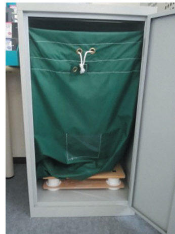
図8 重量計測ユニット設置の様子
