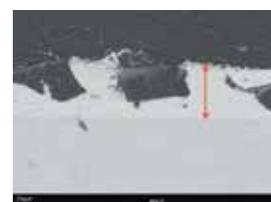
図8 断面(膜厚64 $\mu$ m)
