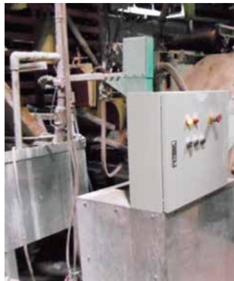
図4 裏面施釉装置の外観 ①裏面施釉前の白地、②裏面施釉後の白地
