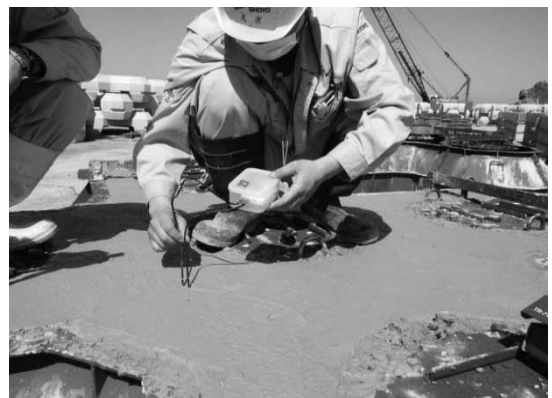
図2 2本の熱電対を挿入する様子
