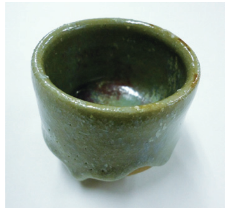
図6(b) 「霞石玄武岩配合ピンク釉薬」を施釉し、登り窯で焼成したぐい呑み (酸化雰囲気, 1250℃以上)
