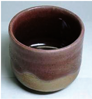
図4 「霞石玄武岩配合ピンク釉薬」を施釉し、電気炉で焼成したぐい呑み (還元雰囲気, 1310℃ - 1h)
