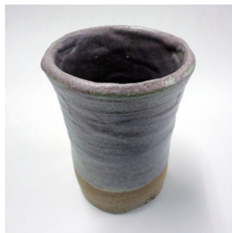
図7 「霞石玄武岩配合ピンク釉薬」を施釉し、ガス窯で焼成したコップ (還元雰囲気, 1280℃ - 15min)
