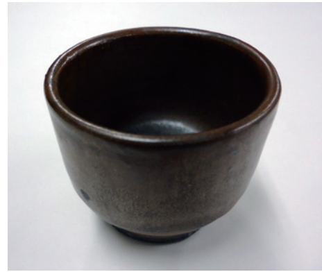
図6(a) 「霞石玄武岩釉薬」を施釉し、登り窯で焼成したぐい呑み (酸化雰囲気, 1250℃以上)
