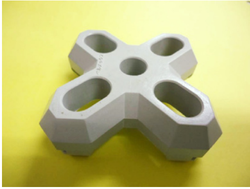
図1 被覆ブロックの外観 (プラスチックの模型)
