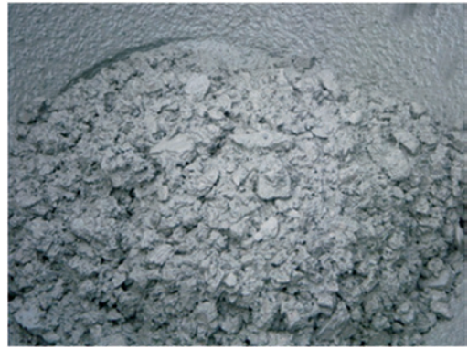
図5 攪拌後ホッパーに排出した生コンの様子
