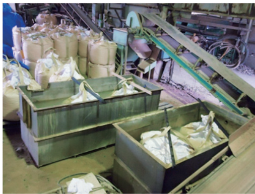
図2 瓦粉碎物の浸漬・吸水時の様子
