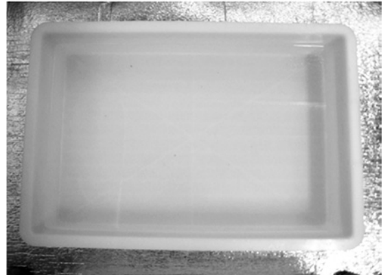
図6(a) 石州E工場の瓦の塩害試験終了後の食塩水
