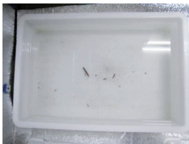
図8 ドイツ製 B 瓦の塩害試験後の外観の一部（上）と使用済み食塩水（下）
