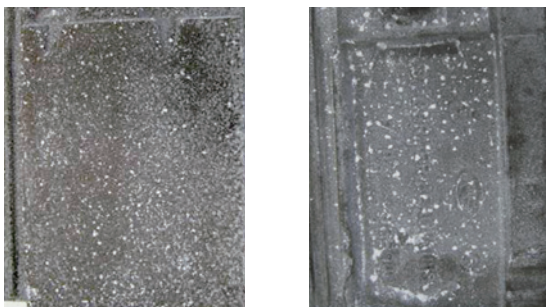
図8 ドイツ製 B 瓦の塩害試験後の外観の一部（上）と使用済み食塩水（下）
