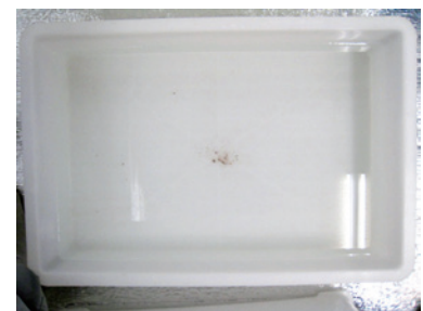
図11 中国製瓦の塩害試験後の外観の一部（上）と使用済み食塩水（下）
