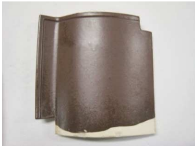
図3 来待釉薬を直火瓦に施釉し、1200℃で2時間熱処理をした直火瓦の外観写真
