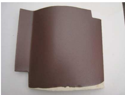
図4 来待釉薬に益田長石（上）とゼオライト（下）を添加した釉薬を施釉し、1200℃で2時間熱処理をした直火瓦の外観写真
