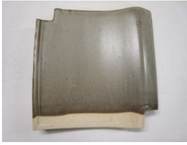
図3 来待釉薬を直火瓦に施釉し、1200℃で2時間熱処理をした直火瓦の外観写真
