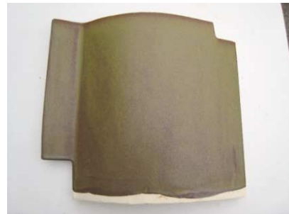
図5 ゼオライトを添加した来待釉薬にマグネタイトを20wt%添加（上）した釉薬と、石灰を10wt%添加した釉薬（下）をそれぞれ施釉し、1200℃で2時間熱処理をした直火瓦の外観写真
