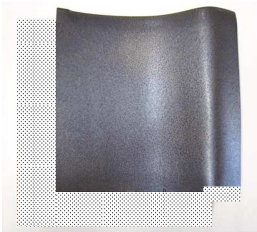
図 8 (b) 塩害試験後の他産地瓦の外観写真
