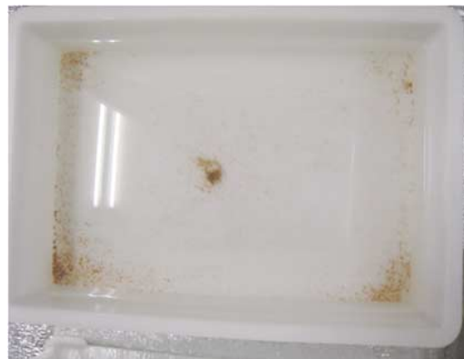
図 9 (b) 他産地釉薬瓦の塩害試験終了後の食塩水の写真
