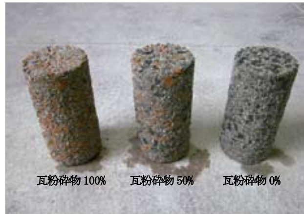
図8 試験体の洗い出し状況
