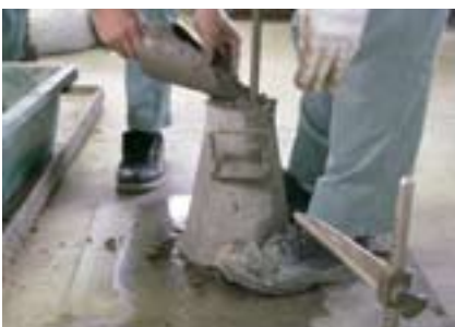
図4 スランブ試験の状況
