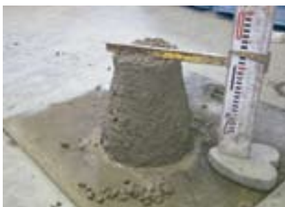
図5 スランブ試験（瓦粉砕物50%）
