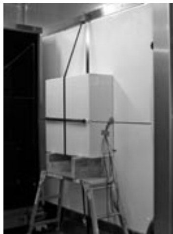
図3 断熱材裏側を恒温槽(屋内側)から見た状態
