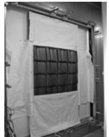
図4 瓦表面を恒温槽(屋外側)から見た状態
