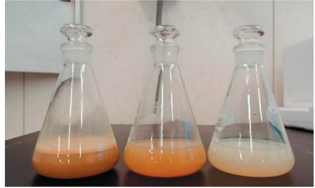
図4 ムコ多糖類精製工程における分解液の外観（左：酵素分解液，中：遠心分離後，右：UF膜精製後）
