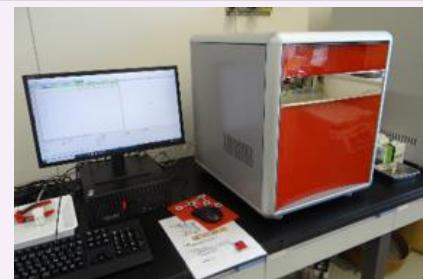
本装置は、通常有機化合物、天然物の構成成分である炭素(C)、水素(H)、窒素(N)、硫黄(S)の含有量を測定・評価する装置です。
