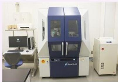
本装置は、固体中の結晶性化合物の種類が同定できます。この結果を基にした半定量分析も実施できます。また、微小部分の測定が可能であり、異物の同定に応用できます。
