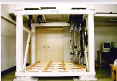
実際の屋根と同様に施工した瓦を繰り返し引き上げる試験を行うことにより、模擬屋根の耐風性能を評価します。
