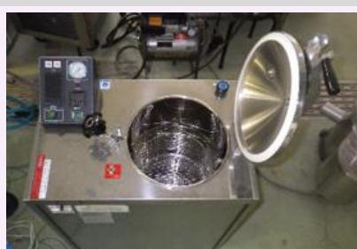
100°C程度の加熱では殺菌が難しい耐熱性菌に有効な高温高压処理が、小ロットで検討可能です。
