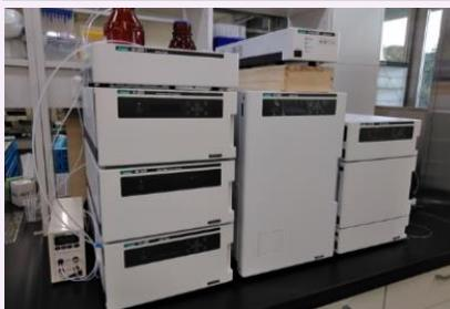
高速液体クロマトグラフ(HPLC)の一種で、樹脂や多糖類などの有機高分子を分子サイズによって分離し、相対分子量や分子量分布を測定するための装置です。
