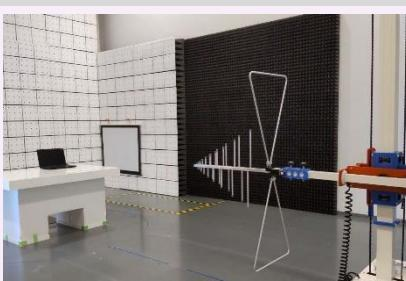
18GHzまでSVSWRでの性能を確認しています。また、プロジェクトがあり、対策効果が暗室内で検証可能です。エア、水道を用意し、様々な計測対象を実動時と同じ状態で評価できます。
