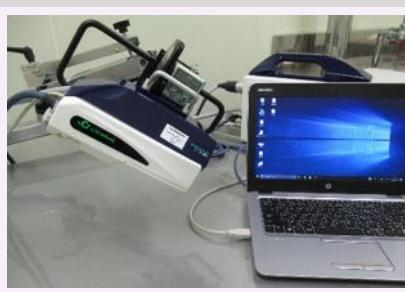
X線回折により結晶面間隔を測定し、材料表面の残留応力や、鉄鋼材料の残留オーステナイト体積率を非破壊で測定できます。また工場等に持ち込んで測定することも可能です。
