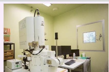
ショットキー型電子銃による高分解能の観察と分析を両立した走査電子顕微鏡で、金属やセラミックスを詳細に観察できます。加熱試料台により1000°Cまでの観察が可能です。
