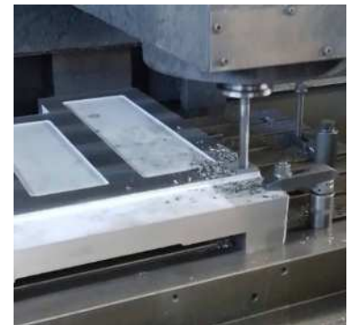
製品実用化試験（加工テスト）の様子 （快削性鋳鉄）
