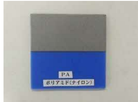
電磁波遮蔽溶射の展示サンプル。樹脂板材にマスキングし、半面にだけ製膜したもの。PA以外にも種類の樹脂材料に製膜可能。
