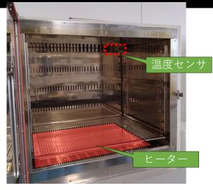
【乾燥器での失敗事例】 乾燥器内部に隙間なくサン プルを詰め込んだところ、 ヒーターの熱が温度センサ に伝わらなくなり、サンプ ル下側が溶けてしまった。
