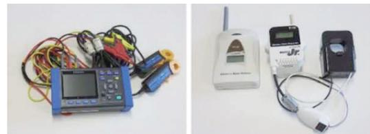
電力計 電流変換器とデータ収集機
