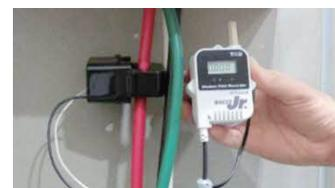
図4 電流変換器による電流の計測
