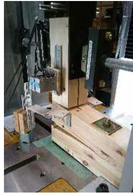
接合部の変位を測定するレーザ式変位計の取り付け
