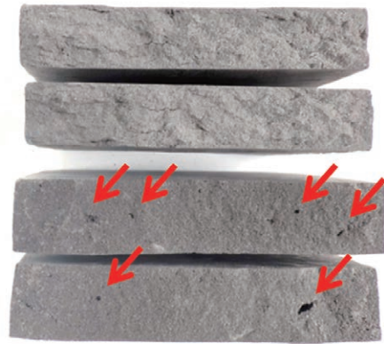
図5 SF 置換した試験体の破断面 (NaOH 水溶液の濃度 上：20wt% , 下：35wt%)
