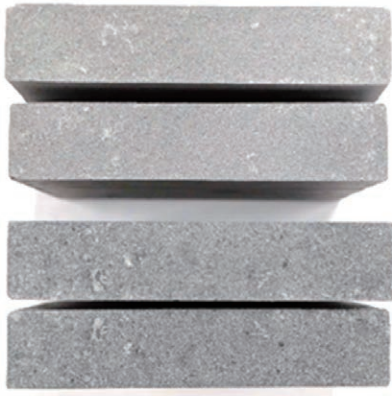
図4 BSF 置換した試験体の破断面 (NaOH 水溶液の濃度 上：20wt% , 下：35wt%)
